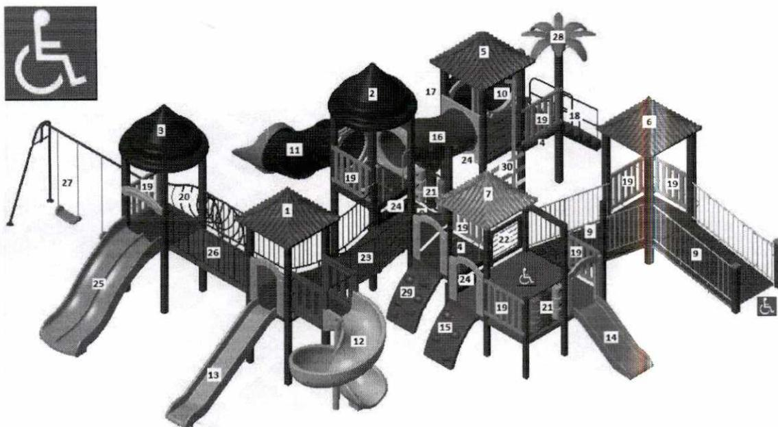
Conjunto de parque infantil colorido (com acessibilidade de PNE), com estrutura principal (colunas) de Madeira Plástica medindo no mínimo 11x11cm e parede de 20mm revestida com acabamento de Polipropileno e Polietileno pigmentado cor itaúba contendo os itens abaixo, podendo as medidas variar até 10% para mais ou para menos:
